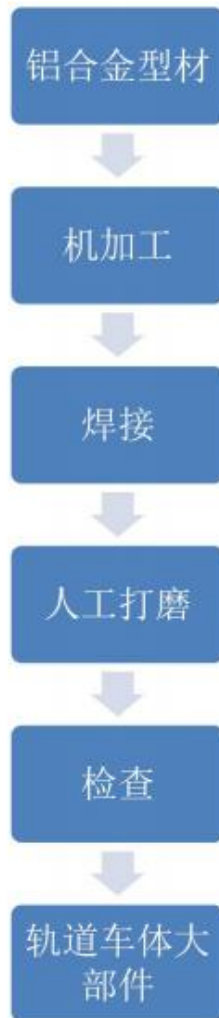
图 3-2 车体车间工艺流程
