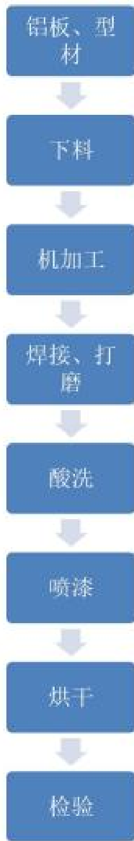
图 3-3 内装车间工艺流程
