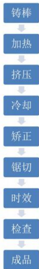
图 3-1 挤压车间生产工艺流程图
